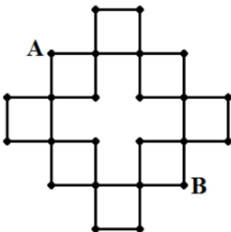
Из одинаковых кусочков проволоки сопротивлением  $R=1$  Ом спаяли фигуру (см. рисунок). Если пренебречь сопротивлением припоя, сопротивление между точками А и В равно Ответ  Ом (округлите до двух знаков после запятой).
