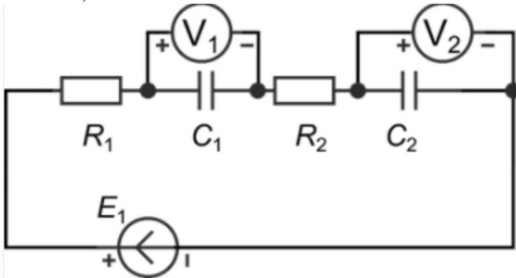
В заданной схеме  $E_1=30$  В,  $R_1=20$  Ом,  $R_2=30$  Ом,  $C_1=10$  мкФ,  $C_2=20$  мкФ. Показания вольтметров (округлите до целых и запишите через запятую без пробелов сначала показания 1-го вольтметра, потом 2-го):
