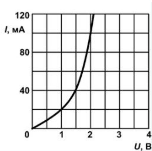
В заданной схеме  $E = 2$  В;  $R_1 = 24$  Ом;  $R_2 = 50$  Ом; вольт-амперная характеристика диода показана на графике. Показание миллиамперметра равно Ответ  мА (округлите до целых).
